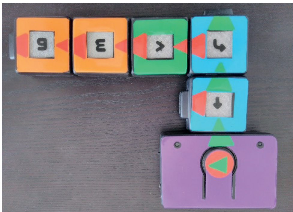
Figura 1 – Blocos de programação tangível do robot MI-GO (andar em frente e virar à esquerda 36°)
