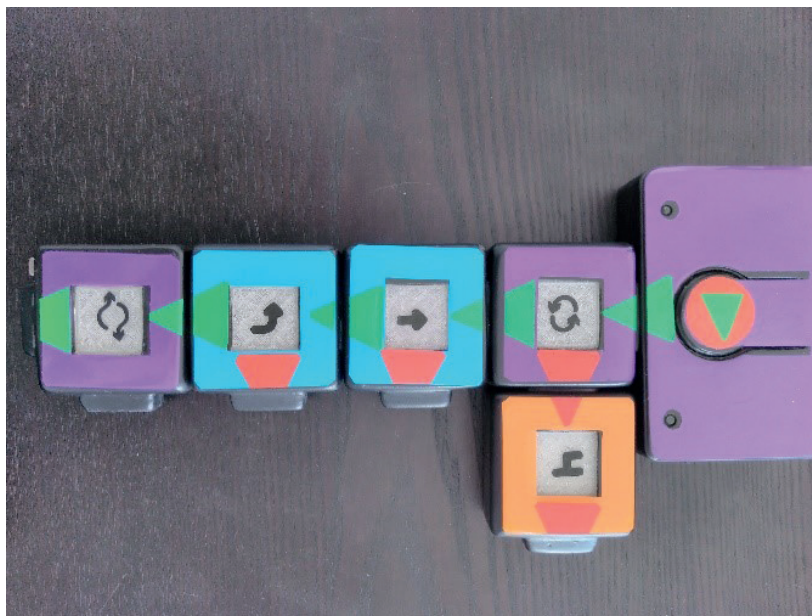
Figura 2 – Sequência de blocos para o robot efetuar um quadrado
